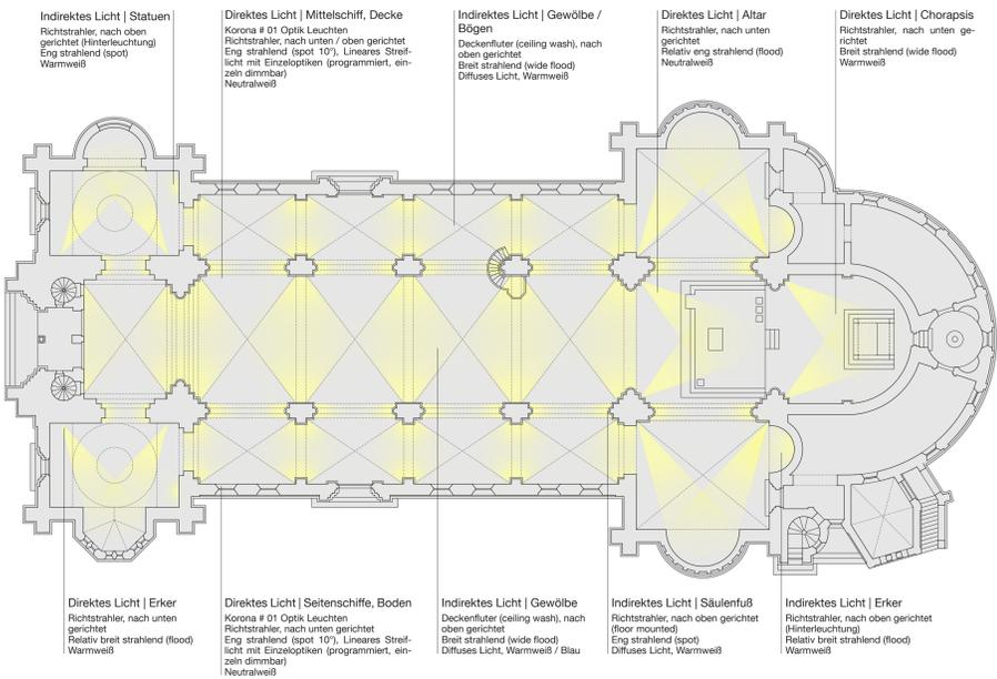
Innenraumbeleuchtung | Mittelschiff und Seitenschiffe, M 1:200
