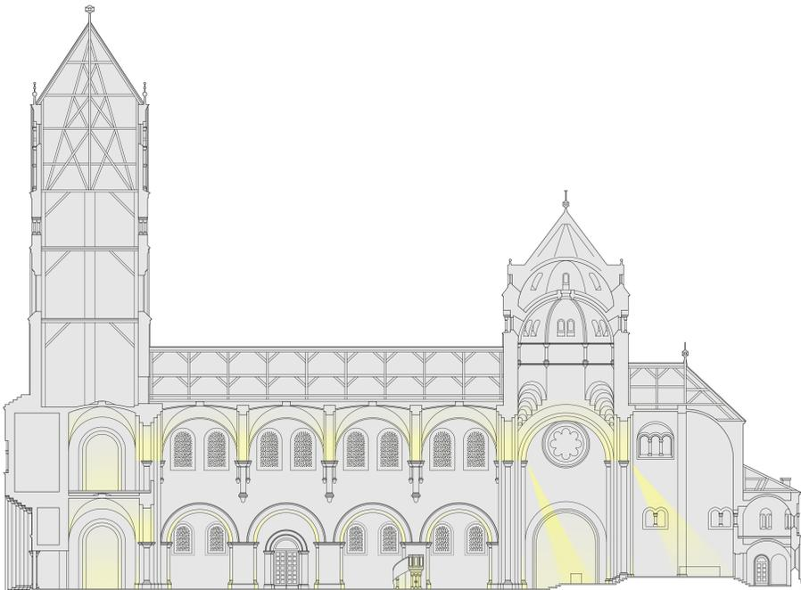
Innenraumbeleuchtung | Längsschnitt Mittelschiff, M 1:200
