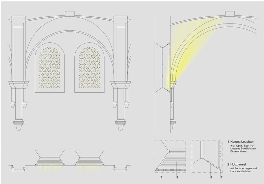
Innenraumbeleuchtung | Mittelschiff, Konzept Lichtpunkte, M 1:50 | M 1:20
