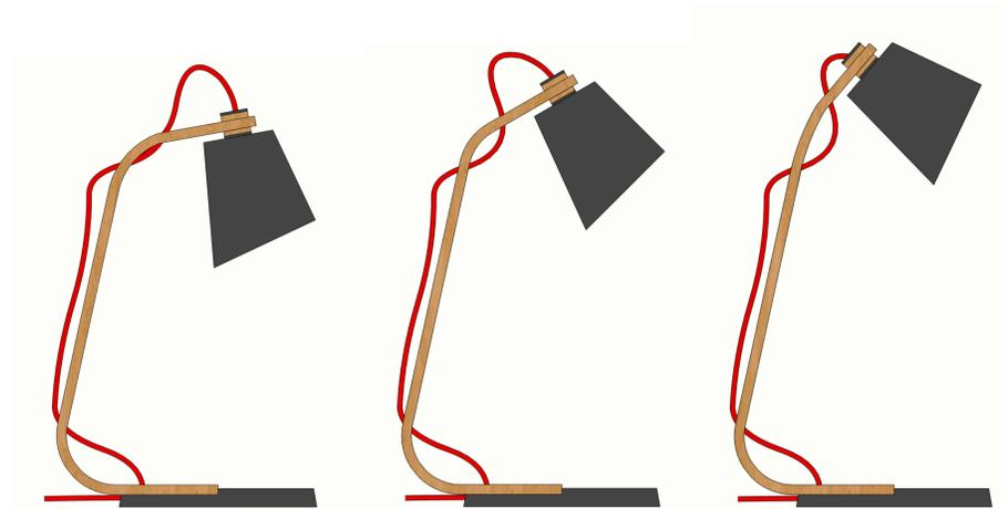
Das Gelenk im Hals lässt sich stufenlos Verstellen. Dies gelingt durch eine Konstruktion von formverleimtem Holz, welches Stellenweise eingelassert und durch einen eingelassenen Biegedraht verstärkt ist. Das Kabel wird durch Löcher im formverleimten Bogen geführt und passt sich der jeweiligen Einstellung der Leuchte an. Der Schirm der Lampe ist drehbar, so lässt sich der Lichtkegel in beliebige Richtungen lenken.
